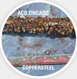
Comparação dos materiais após 10 anos cravados no solo.
